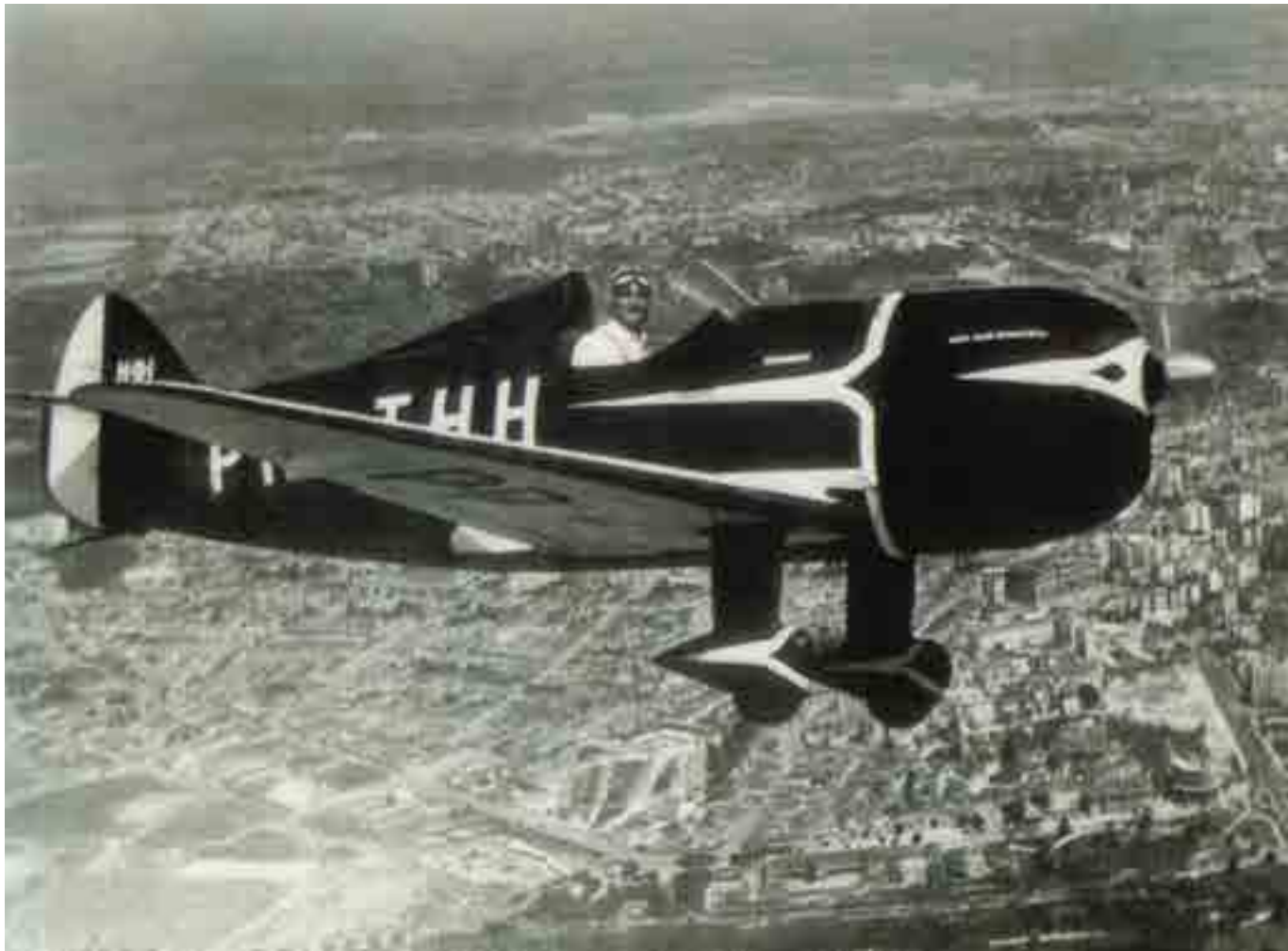
O IPT-0 Bichinho, primeiro avião projetado e construído na Seção de Madeiras do IPT, em 1940
