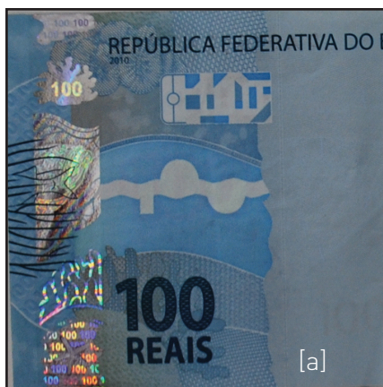
FIGURA 15 - Tinta invisível sob luz ultravioleta: (a) sem incidência de luz UV; (b) com incidência de luz UV.
