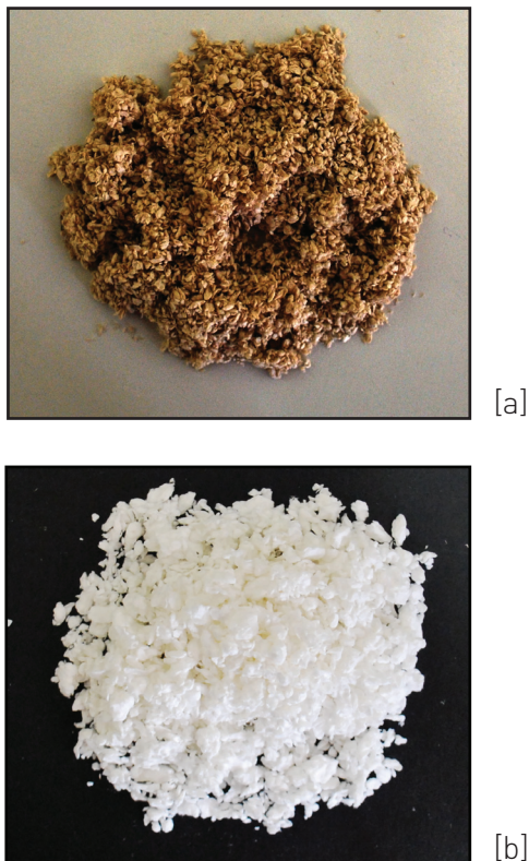
FIGURA 5 - Imagens de pastas celulósicas de eucalipto procedentes de processo químico de polpação: [a] não branqueada; [b] branqueada.
