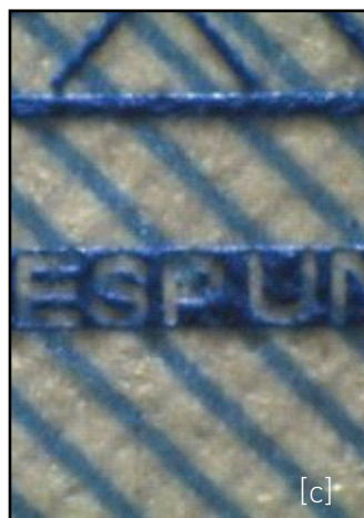
FIGURA 14 - Exemplos de microletra: (a) em forma de linha, (b) cheia, (c) vazadas.
