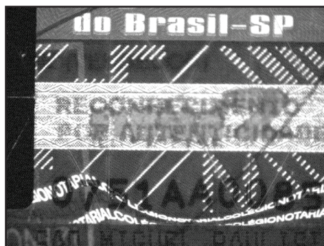
FIGURA E4 - Foto da região alterada da peça de exame obtida do VSC 6000, empregando luz da região do infravermelho.
