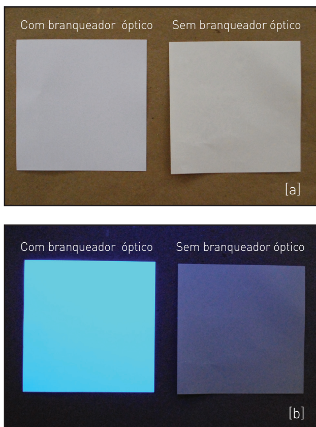
FIGURA 12 - Papéis com e sem branqueador óptico (a) sob luz do dia; (b) sob luz ultravioleta.
