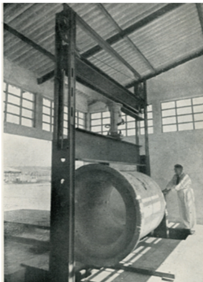
Figura 2 – Máquina para ensaiar a compressão diametral de tubos de grandes dimensões, década de 1940 (projeto e construção do IPT)
