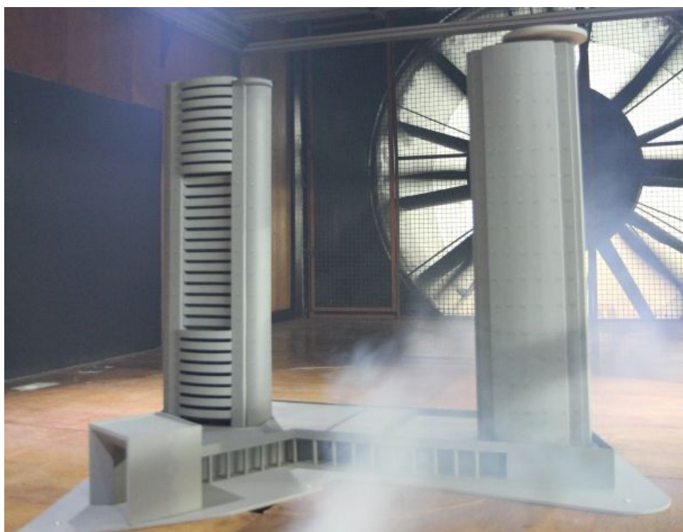
Modelo na seção de testes com visualização de fumaça
