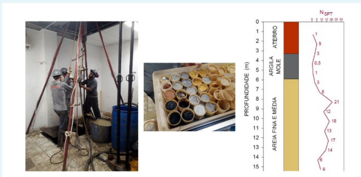
Figura 7 – Descrição do furo de sondagem com dados do ensaio SPT realizado nas proximidades da linha geofísica.
