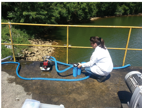
Figura 3.5.12. Imagem de coleta de água superficial para certificação de material de referência de composição de química elementar, para questões ambientais (Acervo LRM/IPT).
