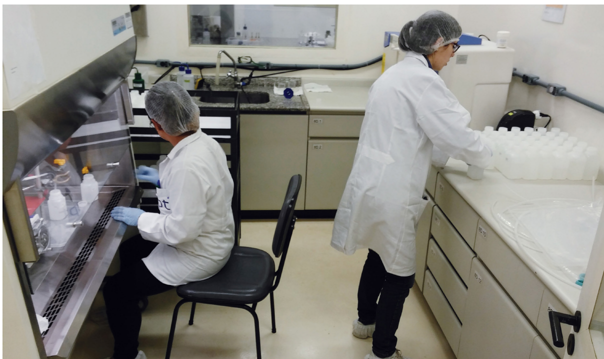
Figura 3.5.13. Imagem da equipe preparando em sala limpa os primeiros lotes experimentais de materiais de referência de águas naturais (Acervo LRM/IPT).
