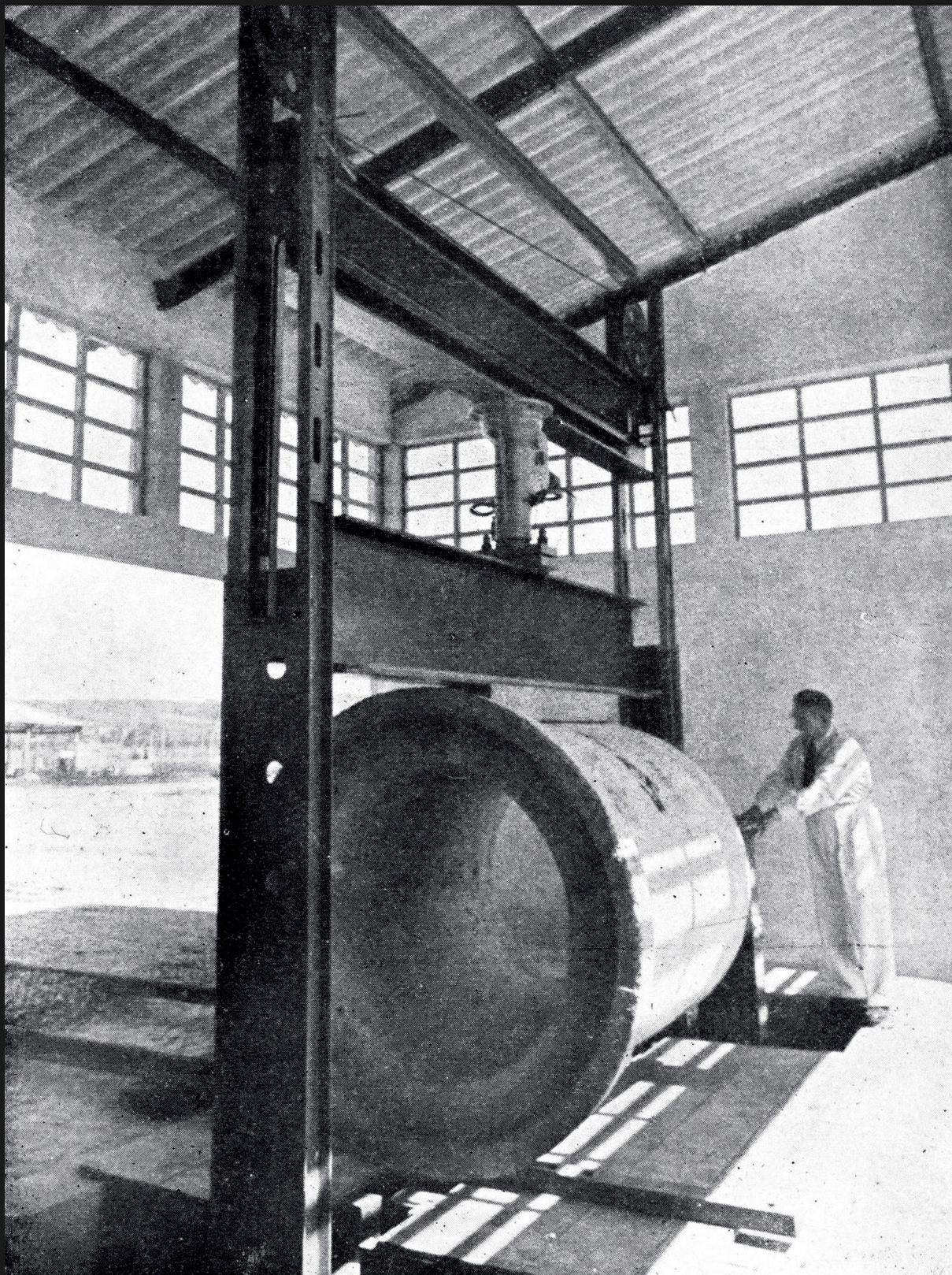
Figura 3.2.11. Imagem de equipamento para compressão diametral de tubos de grandes dimensões, projetado e construído pelo IPT (1, p.123) .
