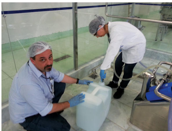
Figura 3.5.11. Imagem de coleta de água subterrânea (poço de insurgência) para certificação de material de referência de composição de elementos químicos tóxicos (Acervo LRM/IPT).
