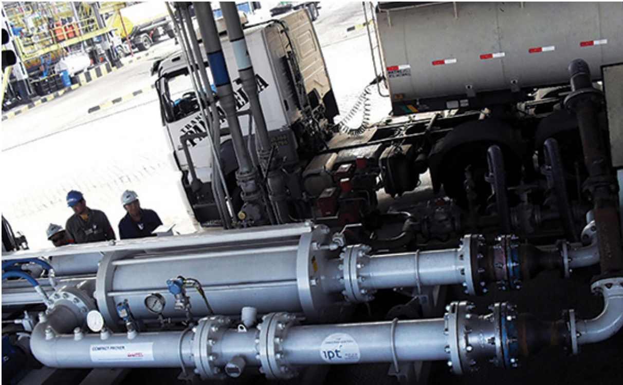
Figura 3.5.5. Imagem da Unidade Móvel do Centro de Metrologia de Fluidos (CMF) para calibração de medidores sob condições reais do processo (8, p.47) .
