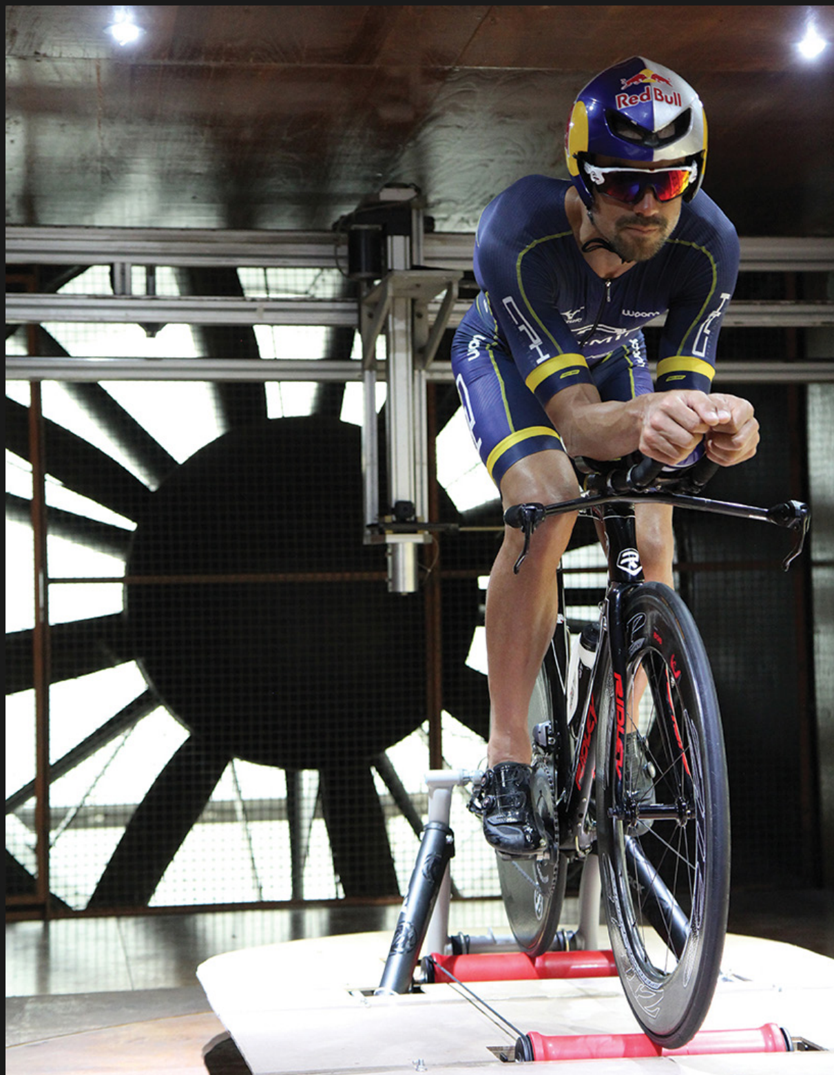
Figura 3.5.10. Em 2016, o triatleta Igor Morelli, realizou teste de aerodinâmica no túnel de vento do Laboratório de Vazão, com o objetivo de correlacionar dados de postura com menor resistência causada pelo ar, assim como obter dados para uma eventual reconfiguração da bicicleta (12, p.49) .
