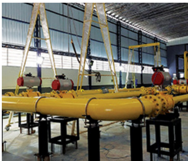
Figura 3.5.36. Imagem do Laboratório de vazão de gás a alta pressão (Acervo LV, 2023).
