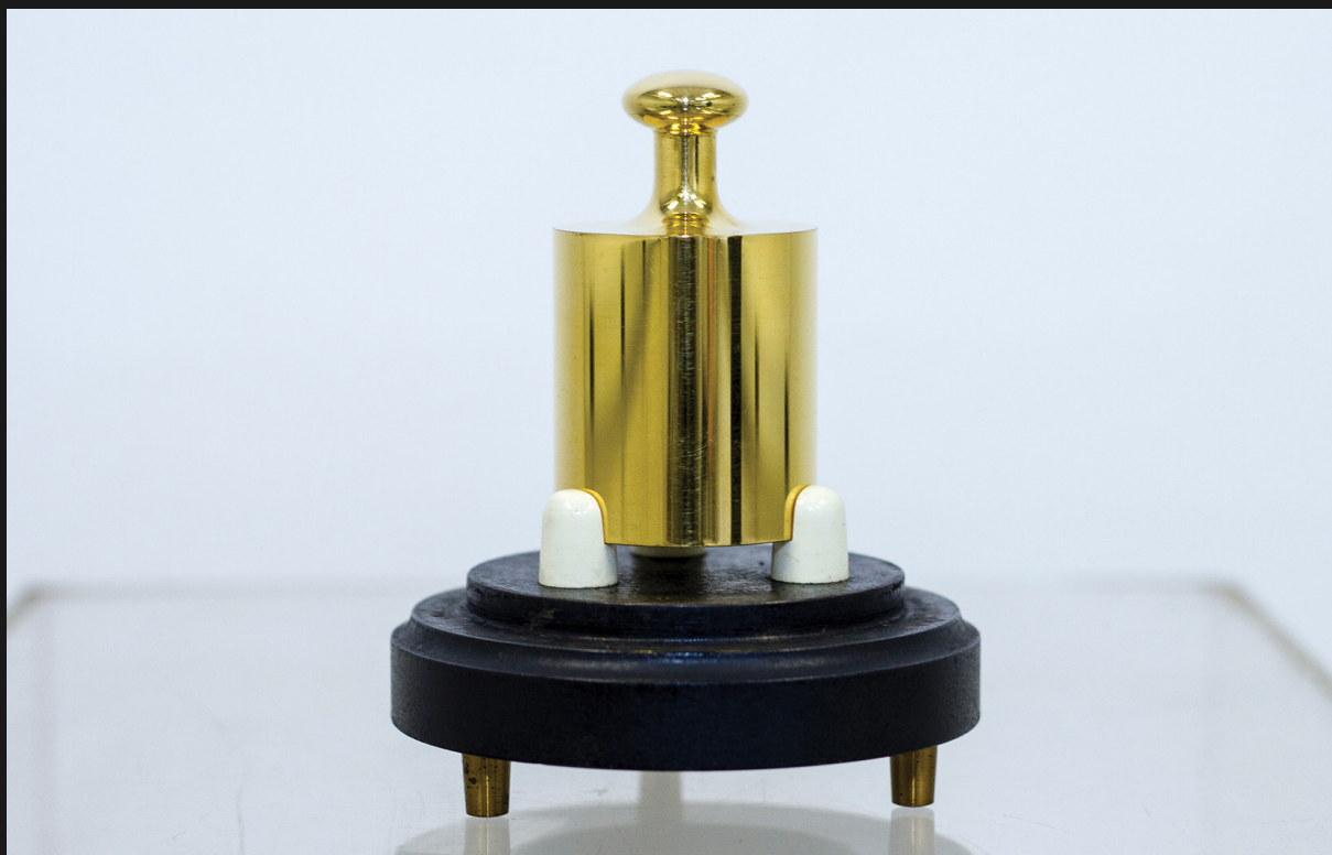
Figura 3.2. Quilograma padrão, adquirido pelo IPT na década de 1930 e certificado pelo Bureau International de Pesos e Medidas (Acervo IPT).
