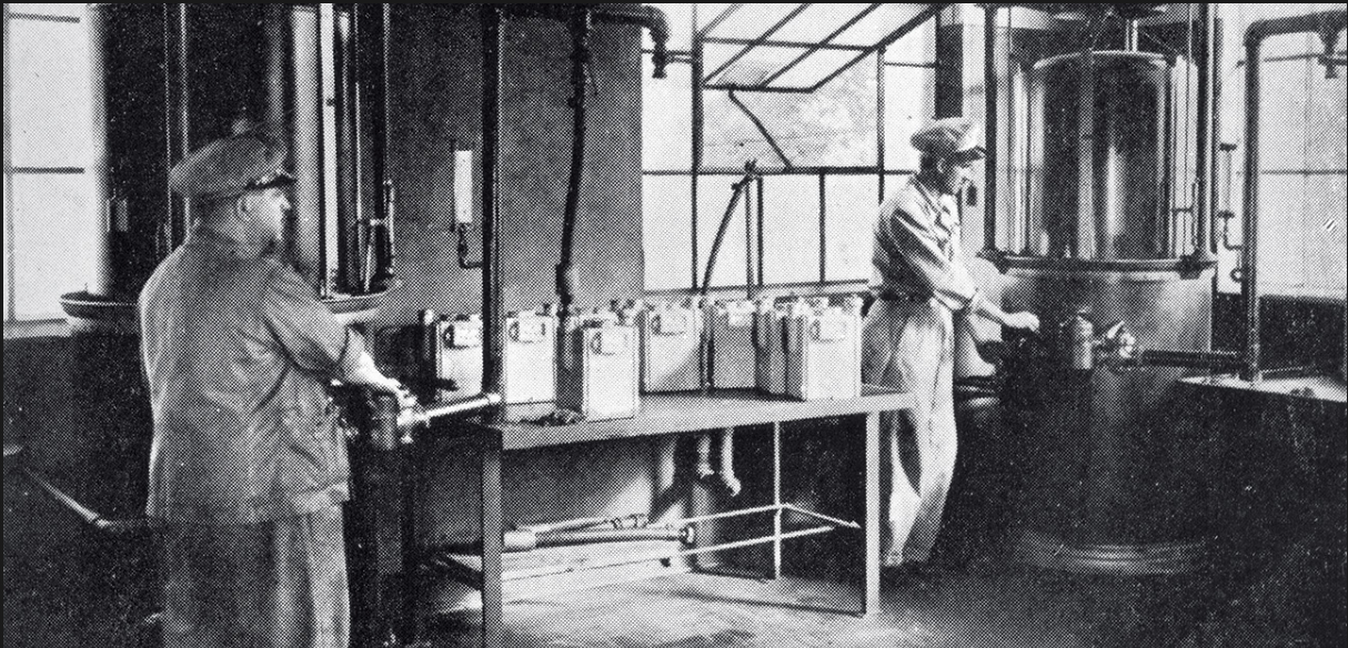
Figura 3.3.6. Imagem de aferição de medidores de gás. A Seção de Metrologia do IPT colabora com a prefeitura de São Paulo, verificando todos os aparelhos para assegurar ao consumidor a justa medição da quantidade de gás consumido (1, p.25) .
