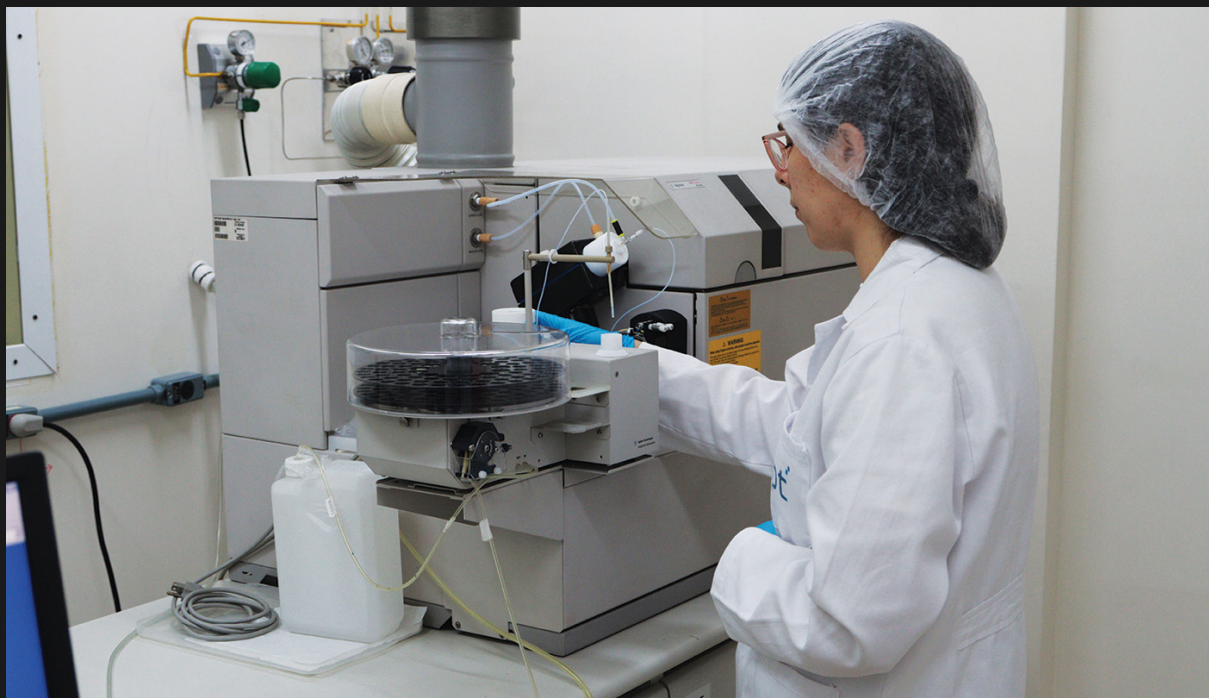
Figura 3.5.3. Imagem de espectrofotômetro de massas com plasma indutivo (ICP-MS) comprado com recursos da Finep em 2008 e usado em quantificação de elementos químicos (Acervo IPT).
