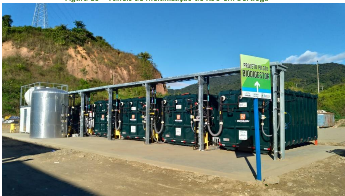
Figura 18 – Túneis de melanização de RSU em Bertioga
