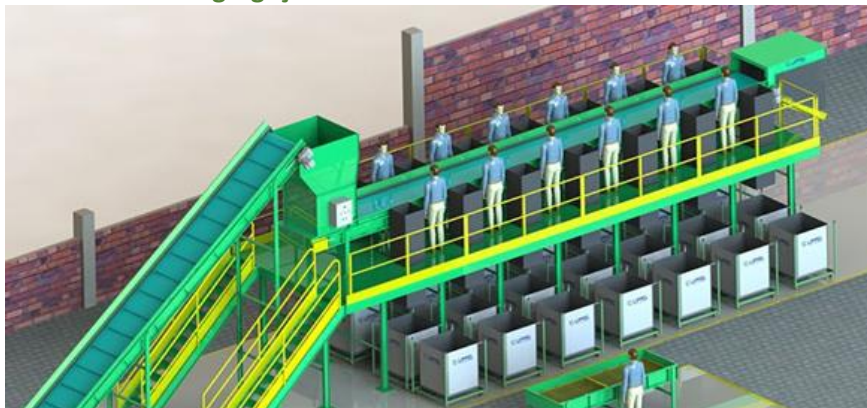
Figura 10 – Sistema de segregação manual em esteiras elevadas
