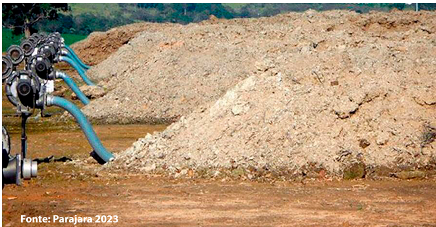
Figura 8 - Unidade de compostagem com sistema de leiras estáticas de aeração forçada em Indaiatuba (SP)
