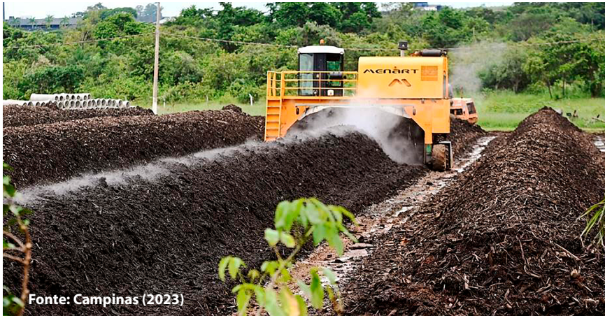
Figura 7 - Unidade de compostagem com sistema de leiras revolvidas em Campinas (SP)
