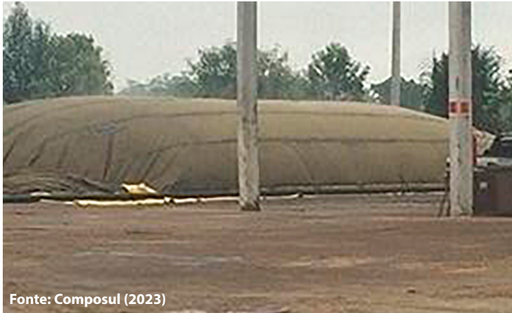
Figura 10 - Unidade de compostagem com sistema de leiras estáticas com manta semipermeável em Içara (SC)
