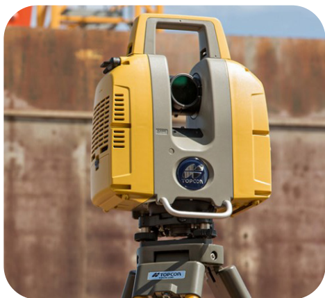
Figura 59 – Uso de scanner para levantamentos de dados geométricos de OAE's.
