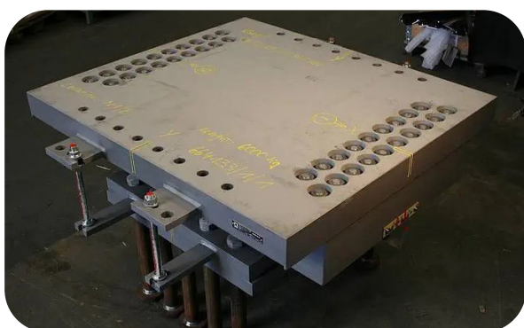
Figura 99 – Vista do aparelho de apoio deslizante montado, com guia lateral impedindo à movimentação de translação perpendicular a guia e permitindo translação na outra direção.
