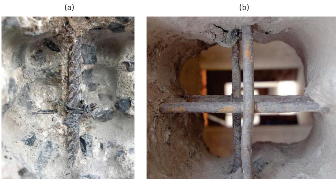
**Figura 39** – Etapa de aspersão de solução colorimétrica após uma das perfurações do concreto (a) e, em seguida, medição da profundidade de carbonatação (b).
