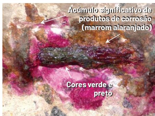
**Figura 44** – Formação de macrocélula em corpo de prova de concreto com reparo localizado (a) e de elemento de estrutura com barra exposta (b). Observa-se o acúmulo de produtos de corrosão no concreto da área adjacente à do reparo (a) e em áreas localizadas de barra exposta com precipitação e lixiviação no concreto, enquanto outras áreas mantêm a coloração acinzentada (b).
