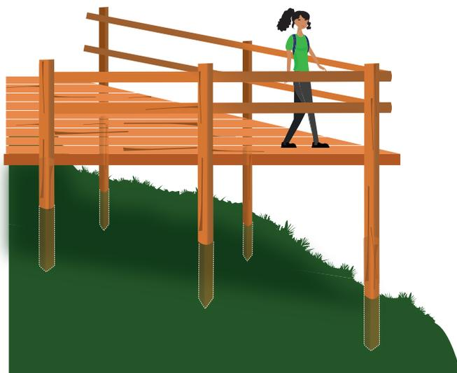
Os procedimentos de manutenção compreendem: a limpeza com remoção de folhas e galhos; substituição de estruturas, como tábua de madeira e guarda-corpo; reforço com parafusos; bem como a substituição de partes maiores. Estes procedimentos visam garantir a melhora da estabilidade da estrutura como um todo.
