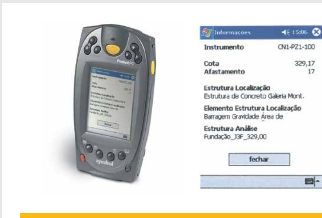
à esquerda: Pocket PC (computador de bolso) operando o SIGESB. à direita: Detalhe do software SIGESB em operação. Fonte: Arquivo IPT.
