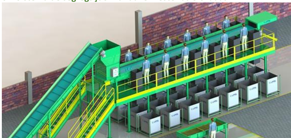
Figura 10 – Sistema de segregação manual em esteiras elevadas
