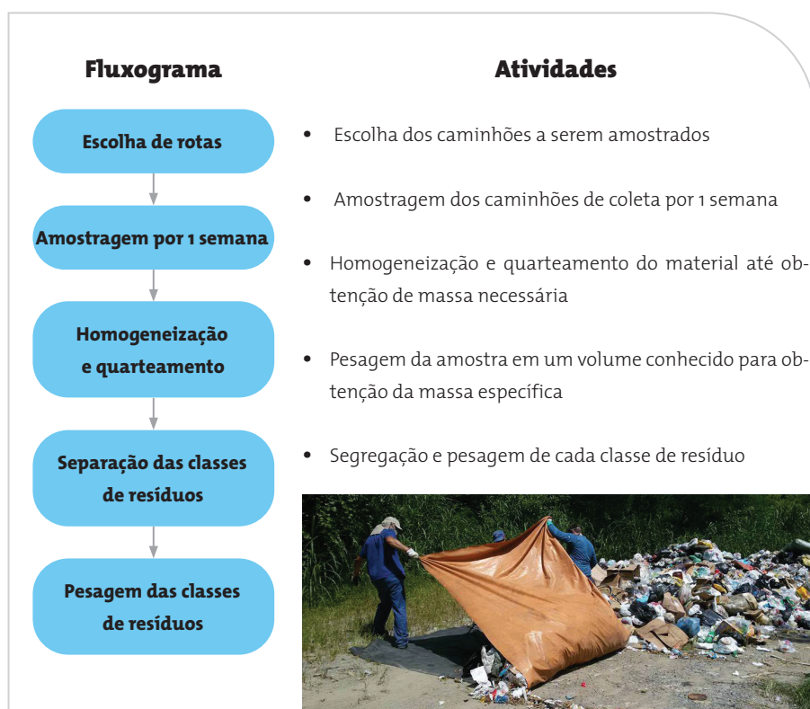
Fluxograma de atividades do ensaio de determinação da composição física e gravimétrica de resíduos de poda e supressão de árvores
