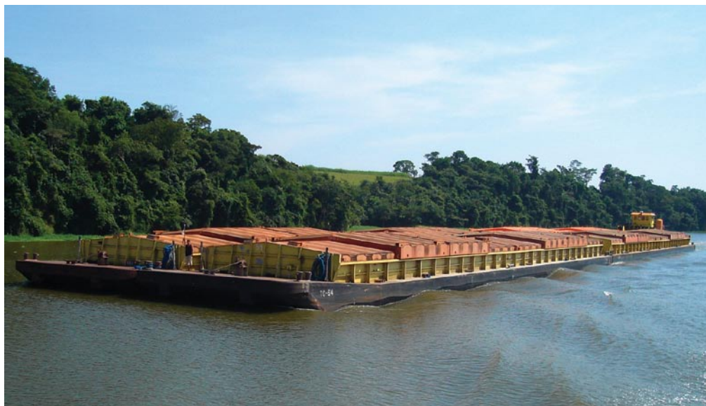
Figura 7 – Transporte de 6.000 t de soja em chatas, na hidrovía Tietê, SP. Notar a ondulação do rio, que provoca erosão em suas margens e turbidez da água.
