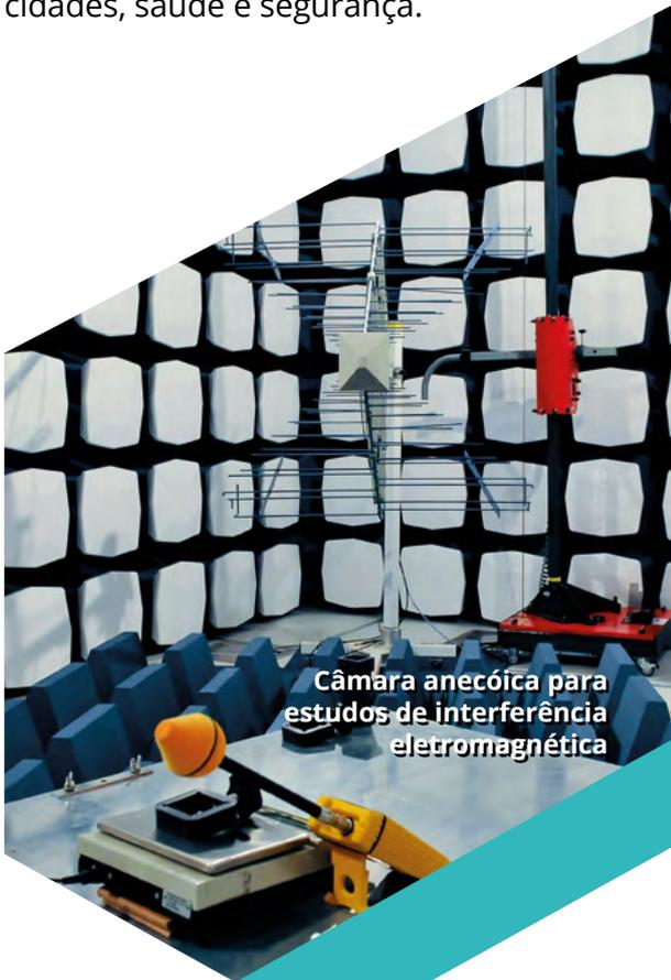
**Câmara anecóica para estudos de interferência eletromagnética**
