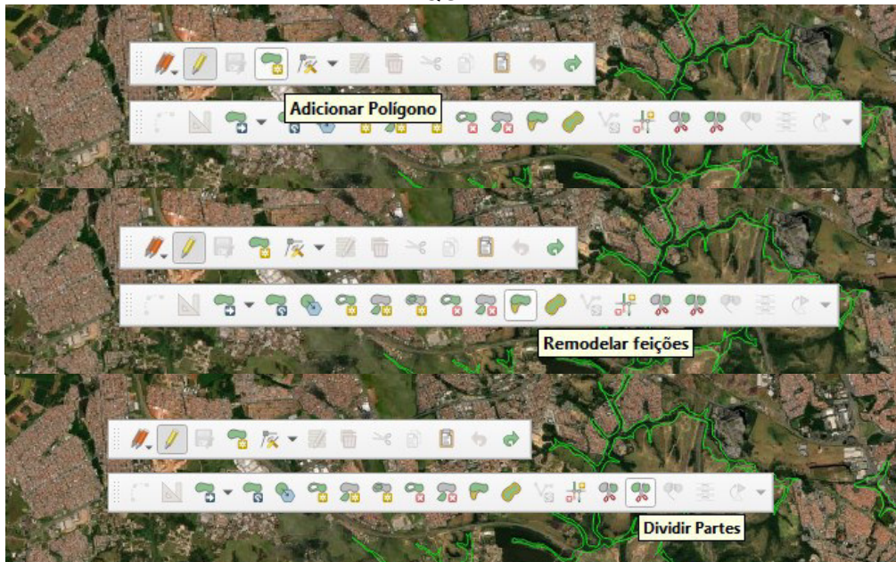
Figura 17 - Localização das principais ferramentas de edição nas barras de ferramentas do QGIS.
