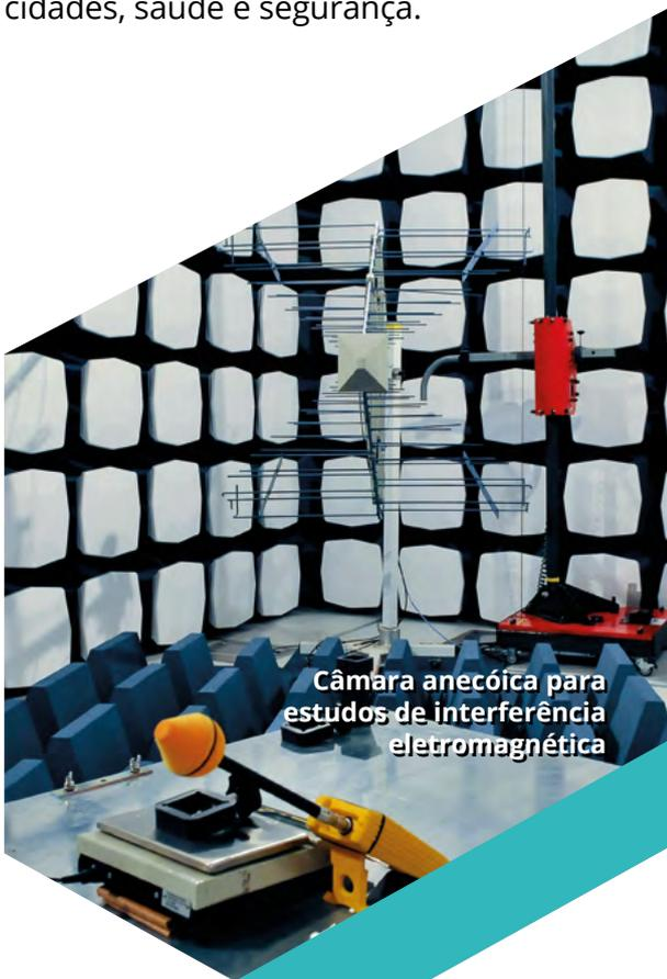
**Câmara anecóica para estudos de interferência eletromagnética**
