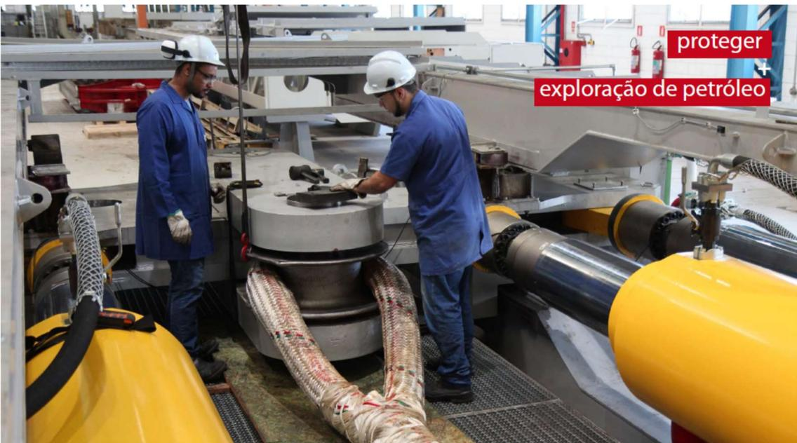
O IPT inaugurou um equipamento único no hemisfério sul para **ensaios de elementos de ancoragem**. A bancada permite desenvolver e qualificar amarras, umbilicais e risers para exploração de petróleo em águas profundas.
