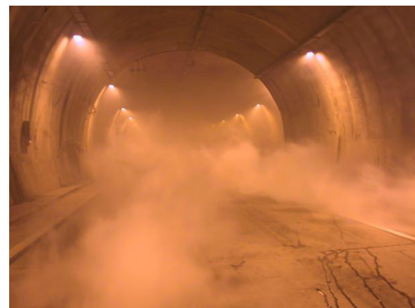
Simulação com fumaça para teste dos sistemas de segurança. O IPT também avalia o impacto da fumaça dos pneus
