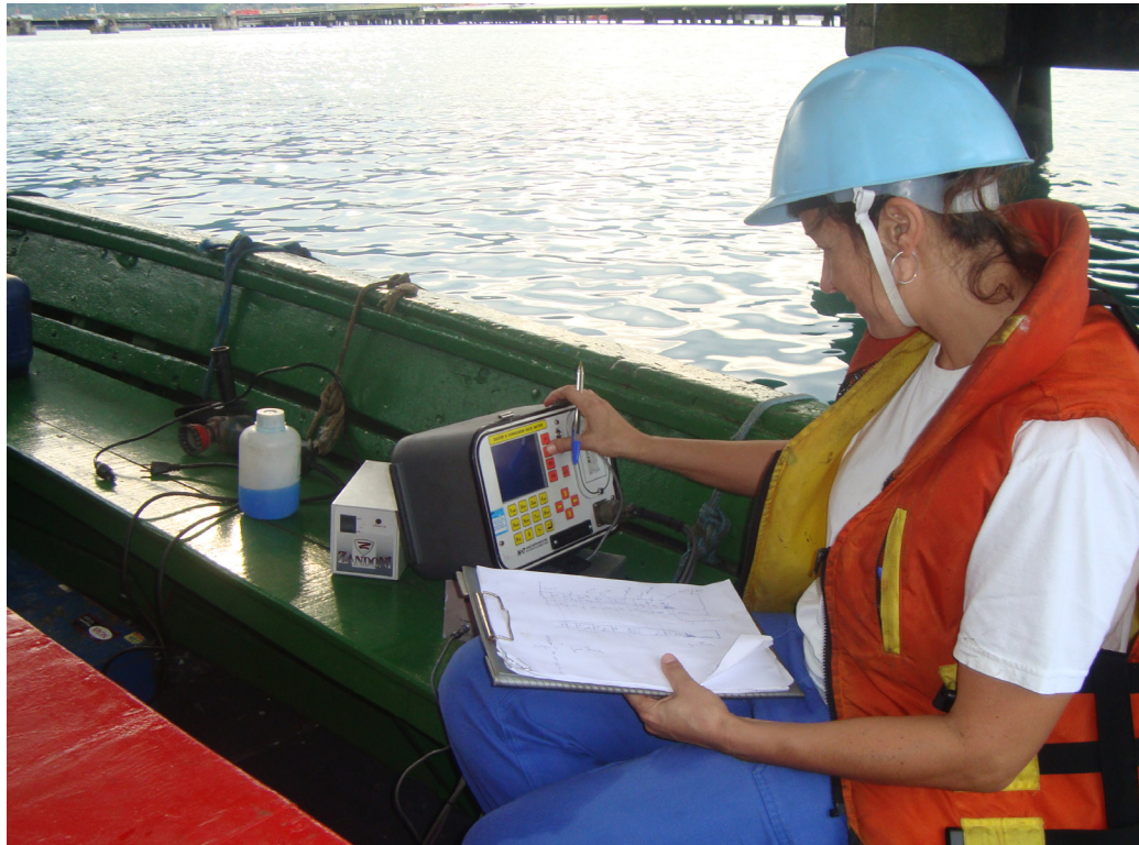
À esq., inspeção de armaduras em campo. Abaixo, ensaios eletroquímicos em amostras de concreto com armadura de aço inoxidável
