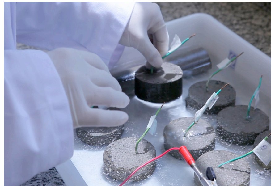
À esq., inspeção de armaduras em campo. Abaixo, ensaios eletroquímicos em amostras de concreto com armadura de aço inoxidável
