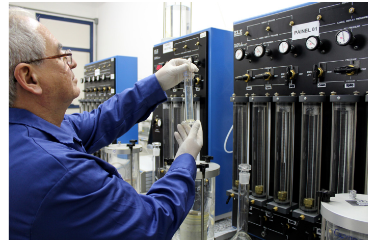
Teste de parâmetros de transporte de poluente em amostras de solo não contaminado
