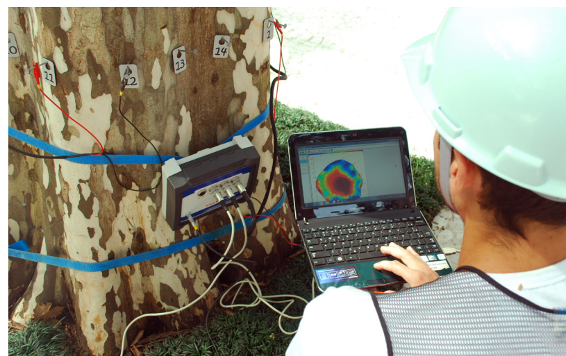
Tomógrafos adquiridos pelo IPT permitem avaliar a condição da árvore e detectar deteriorações por meio de ensaios não destrutivos
