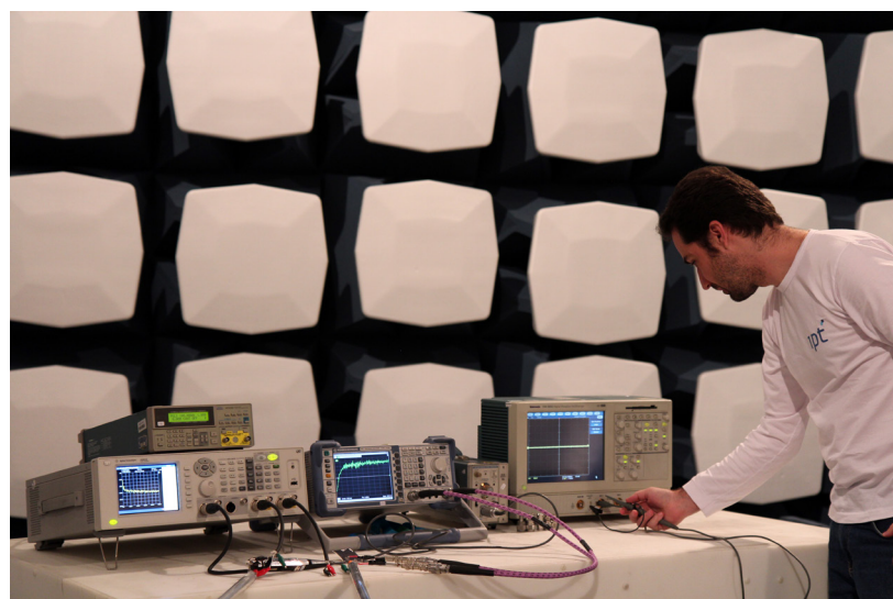
Medição do fator de blindagem de cabos de pares trançados para instrumentação
